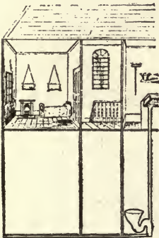
Fig. 629. Untrapped sink waste.
